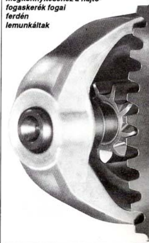
26. ábra. Az összekapcsolódás megkönnyítéséhez a hajtófogaskerék fogai ferdén lemnakáltak
