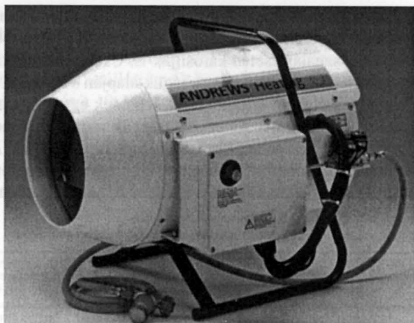
15. ábra. Szén-dioxid-trágyázó berendezés, amely propán-bután gáz elégetésével működik (fotó: dr. Terbe István)
