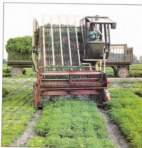
33. kép. Levélpetrezselyem betakarítógép vágás közben (Rimóczi, 1997)
